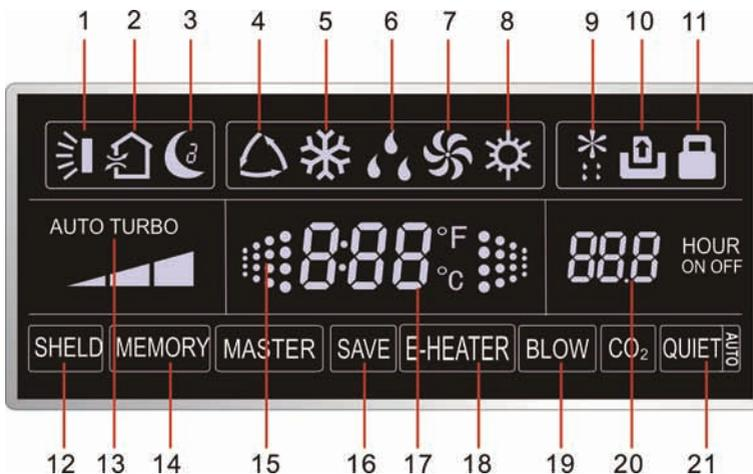
Fig.1.1.2 LCD display
