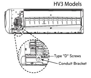
Figure 61: Installing Bracket for Conduit (090HEV)
