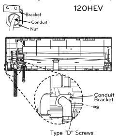
Figure 63: Installing Bracket for Conduit (180HEV, 240HEV)
