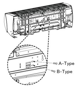
Figure 16: Installation Plate - 120HEV
