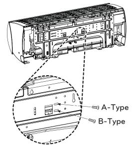
Figure 8: Installation Plate - 181HSV3, 180HEV, 240HEV
