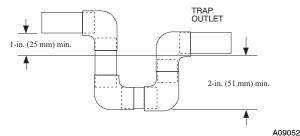
Fig. 8 - Condensate Trap
